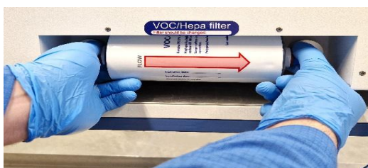
Obrázek 12.2 Postup vkládání a vyjímání filtru VOC/HEPA
