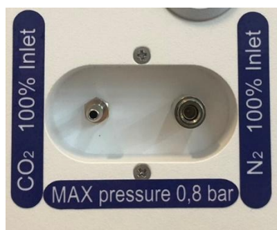
Obrázek 11.1 Vstupy pro plyny na zadní straně vícekomorový IVF inkubátoru MIRI® II-12
